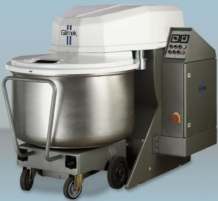
**Основание:** Нижнее основание и узел месильного органа сделаны из чугуна. **Привод:** Двухскоростной 9,5/4,5 кВт двигатель приводит в движение спираль через трансмиссию. Дежа приводится в движение двигателем с редуктором через цепь в масляной ванне и через привод с нижней стороны дежи.
