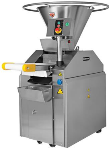
Тестоделитель TVD 3000 вакуумно-поршневой
